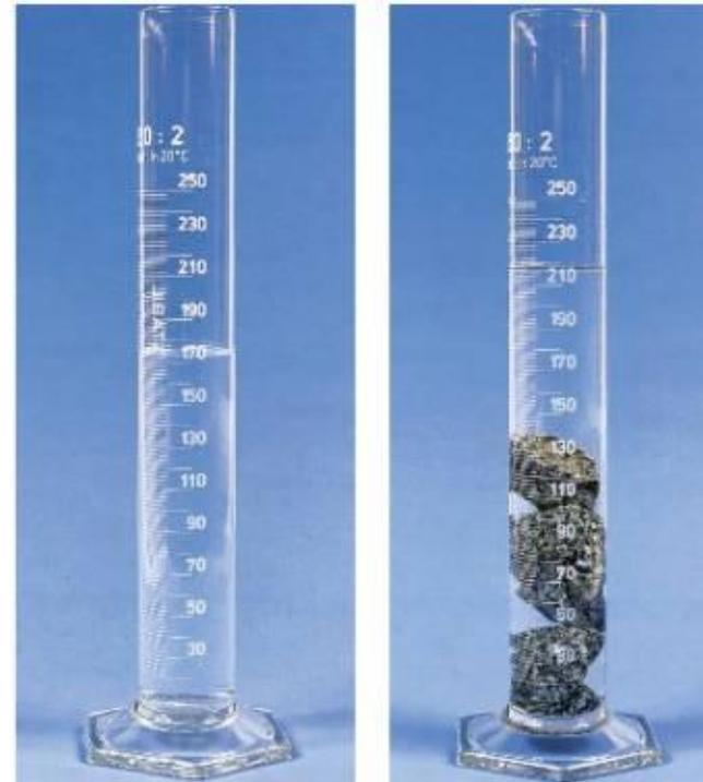
**Densité = masse volumique de l'échantillon / masse volumique de l'eau**
