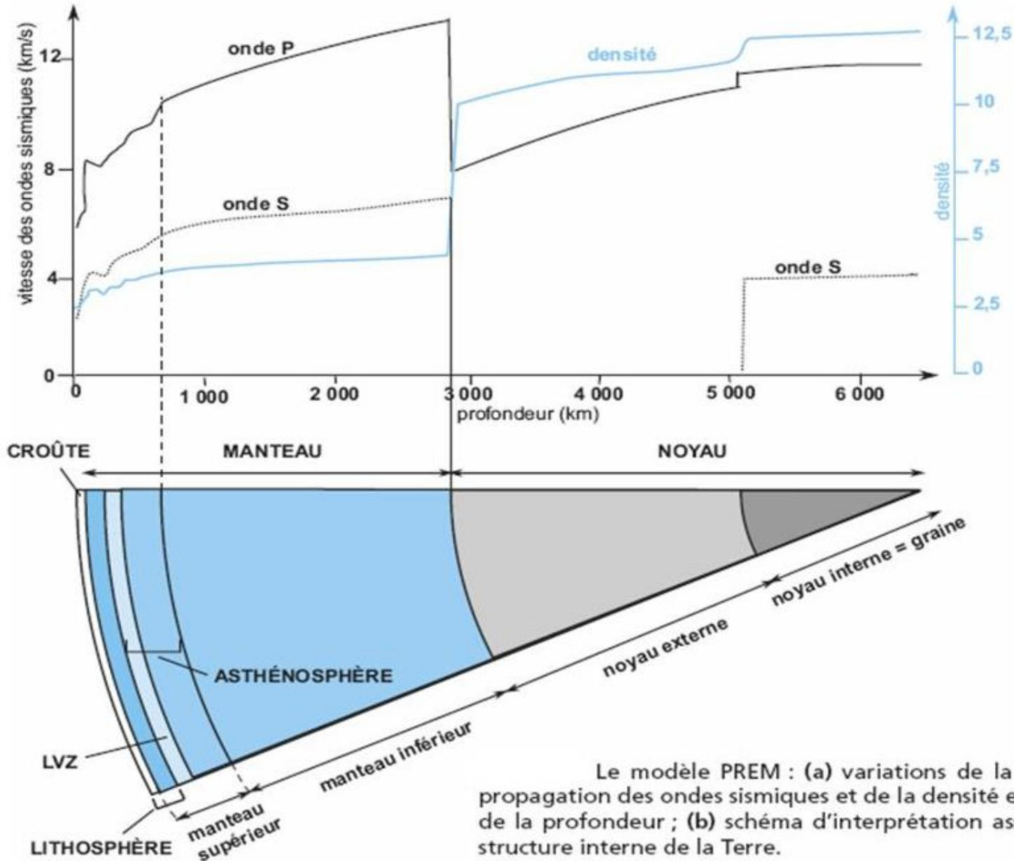
Le modèle PREM : (a) variations de la vitesse de propagation des ondes sismiques et de la densité en fonction de la profondeur ; (b) schéma d'interprétation associé de la structure interne de la Terre.
