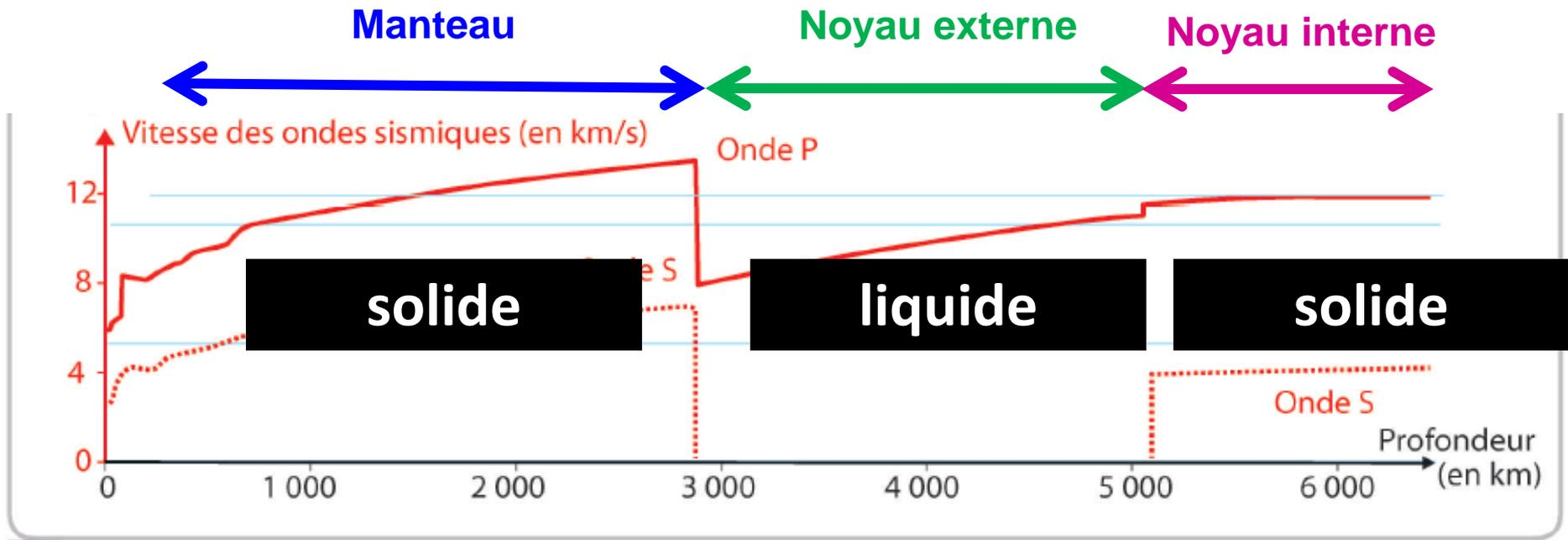
**e** Une discontinuité au sein du noyau. En 1936, Inge Lehmann repère sur des sismogrammes, des ondes P très atténuées qui, selon elle, ont traversé le noyau en subissant plusieurs réfractations. En s'enfonçant dans le noyau, à 5 150 km de profondeur, une onde P peut donner naissance à une onde S par réfraction, et inversement lorsqu'elle remonte vers la surface.
