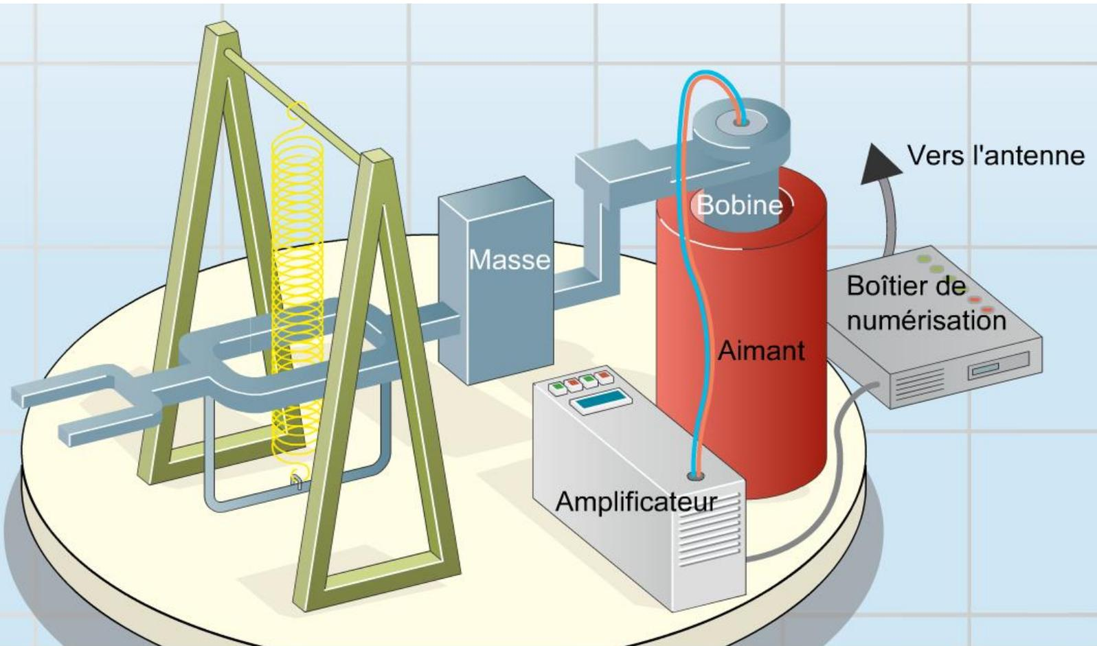
Une masse **assez lourde est fixée sur un bras** suspendu par un ressort au-dessus d'un bâti solide du sol. À l'autre extrémité du bras, une **bobine conductrice** est plongée dans un **aimant** qui repose sur le bâti.
