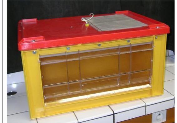
Une boîte à UV est une enceinte dans laquelle on peut soumettre les levures à des rayonnements UV. Cette boîte est protégée de façon à ce que le manipulateur ne soit pas exposé aux UV.
