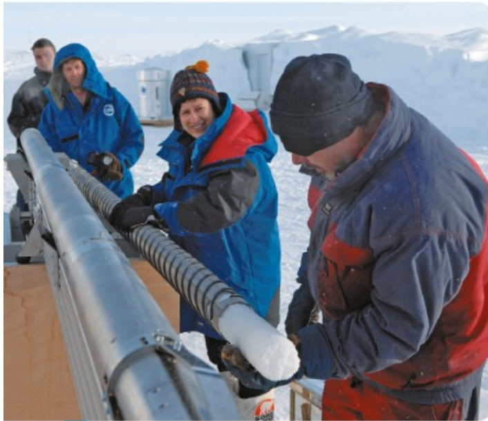
8 Carotte de glace en Antarctique. Le \delta^{18}\text{O} est calculé à partir de carottages.
