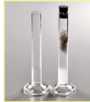
3. Placer dans le tube un tampon de coton contenant des pastilles de potasse.
