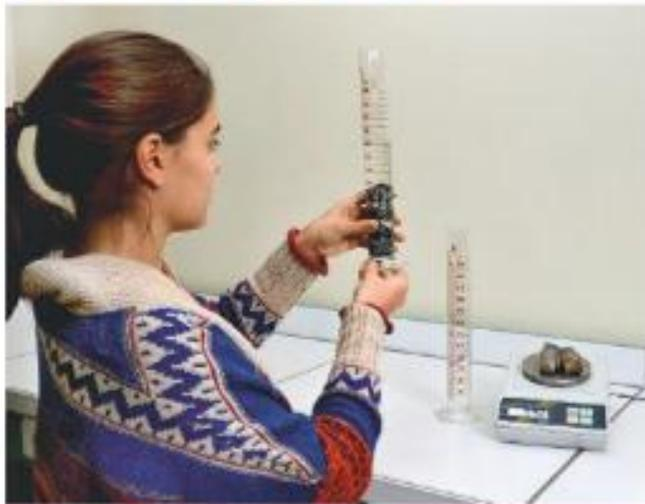
En utilisant le protocole décrit page 147 (*document 3*), déterminer la densité d'un schiste bleu (métagabbro à glaucophane) et d'une éclogite. On rappelle que la densité s'exprime par la même valeur que la masse volumique, mais sans unité puisqu'il s'agit d'un rapport de deux masses volumiques.
